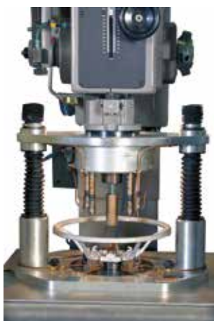
Détail de perçage avec tête multibroches de volants de véhicules.
