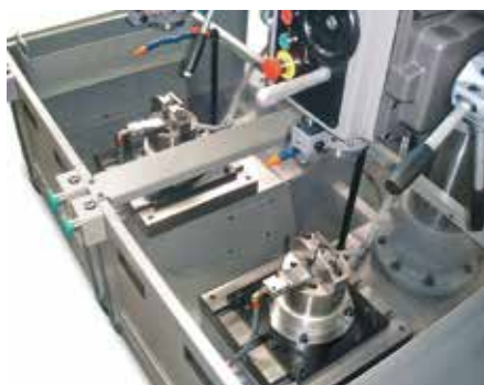
Détail d'outils de serrage auto-centrants hydrauliques de rotules de suspension automobile.
