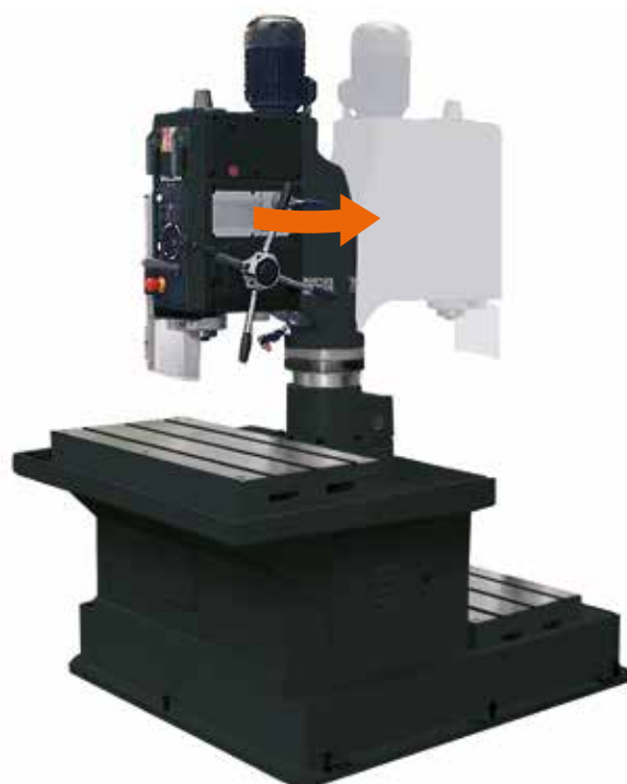
Perçage avec tête tournante sur base à double table. La table du bas à l'arrière permet des travaux sur des pièces volumineuses.
