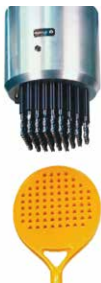
Application de perçage simultané de 76 trous sur raquette de paddle.
