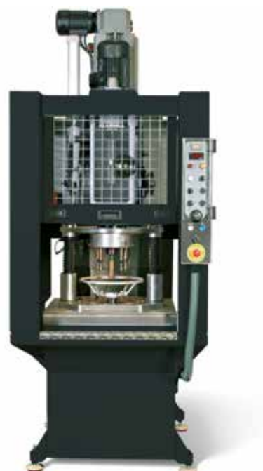
Unité de perçage à tête multibroches pour volants de véhicules automobiles avec un suivi rigoureux des normes techniques et de sécurité du client.
