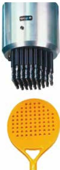
Anwendung des gleichzeitigen Bohrens von 76 Löchern in einen Paddelschläger.
