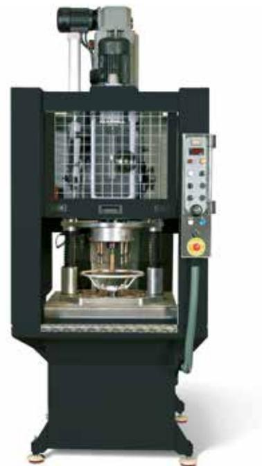
Bohreinheit mit Mehrspindelkopf zum Bearbeiten
