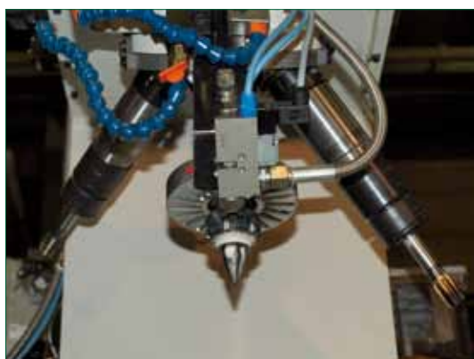
- Detalle de herramienta de fluotaladrado en centro de taladrado con cabezal revolver de 8 herramientas.
