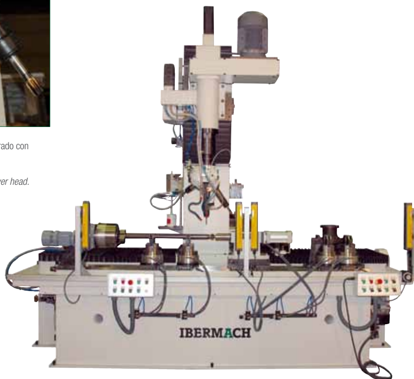
- Centro de taladrado con cabezal revolver de 8 herramientas. Preparado para operaciones de fluotaladrado y fluoroscado. Equipado con plato de amarre controlado para giro de pieza.
