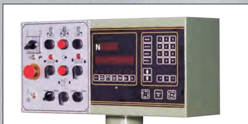
VISUALIZADOR 1, 2 ó 3 EJES 1, 2 or 3 AXES VIEWER VISUALISATEUR 1, 2 ou 3 AXES ANZEIGE 1, 2 oder 3 AXSEN
