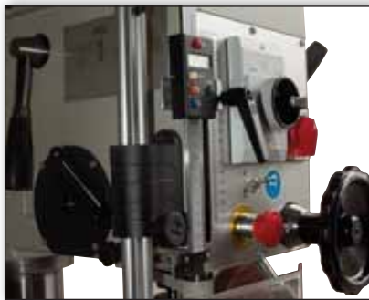
Lector digital de profundidad Depth digital reading Lecteur digital de profondeur Tief digitale Lesegerät
